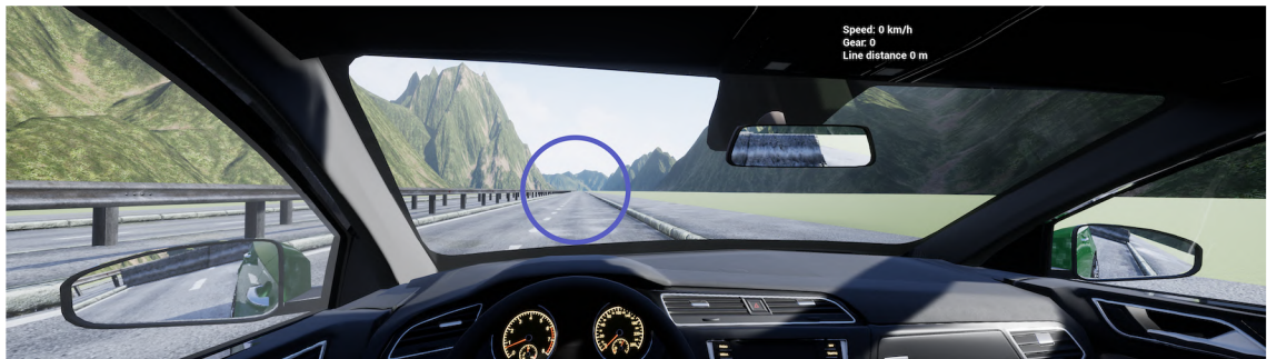
Obr. 2.5: Obrazovka simulátoru s vyznačenou tolerancí \pm 10 cm
