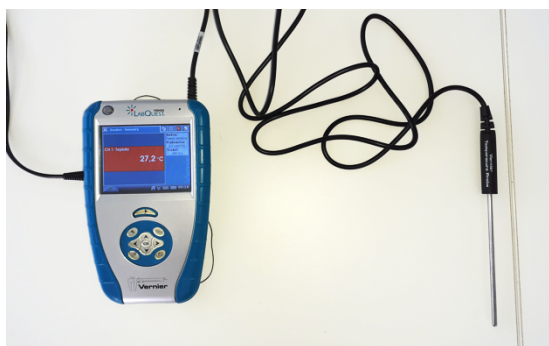
Obrázek 5: Fotografie staršího typu dataloggeru (s označením LABQUEST 1) a čidla na měření teploty (vlevo) a nejnovějšího typu dataloggeru (s označením LABQUEST 3) od firmy VERNIER (vpravo). Fotografie vlevo byla pořízena autorem pracovního listu a vpravo byla stažena z https://www.vernier.com/wp-content/uploads/2020/08/product.labq3_002.right.screenshot.jpg .
