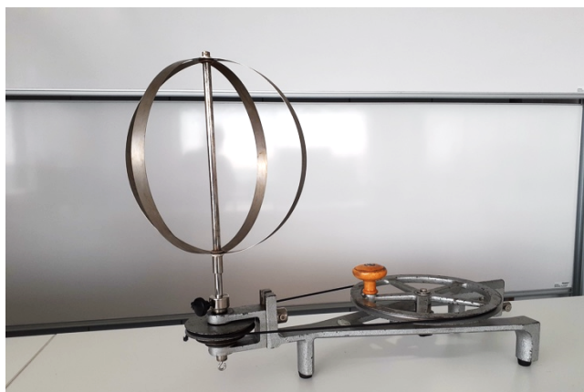
Obrázek 9: Fotografie odstředivého stroje s modelem koule. Pořízeno autorem pracovního listu v laboratoři.
