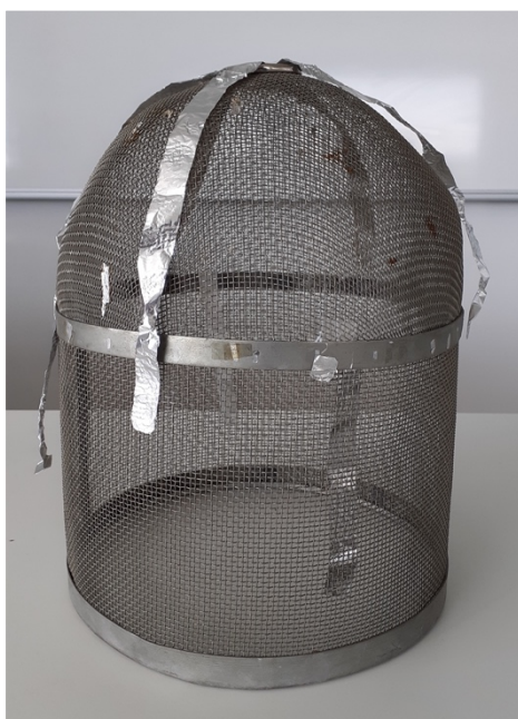
Obrázek 14: Fotografie modelu Faradayovy klece s proužky z alobalu. Snímek byl pořízen autorem tohoto pracovního listu v laboratoři.
