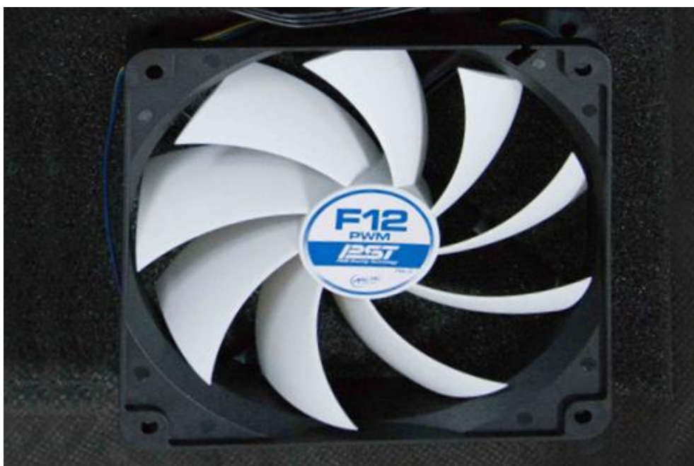
Obrázek 17 - Ventilátor 120 mm, 600-1350 ot./min
