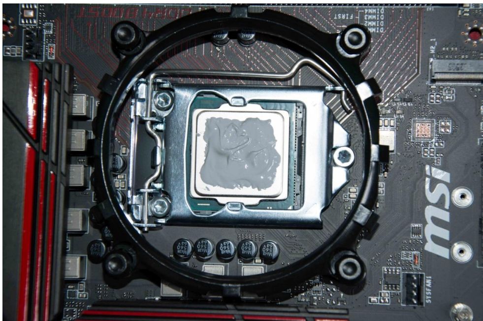
Obrázek 8 - Nosná konstrukce chladiče a nanesená teplovodivá pasta
