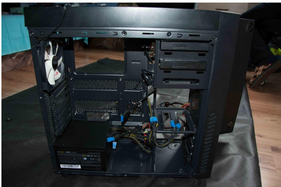
Obrázek 3 - Upevněný zdroj a připravené kabely
