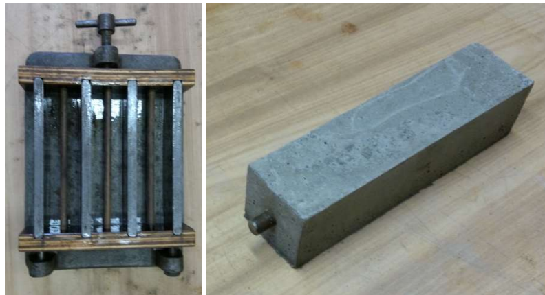
Obr. 66 Uložení výztuže v neutrální ose
