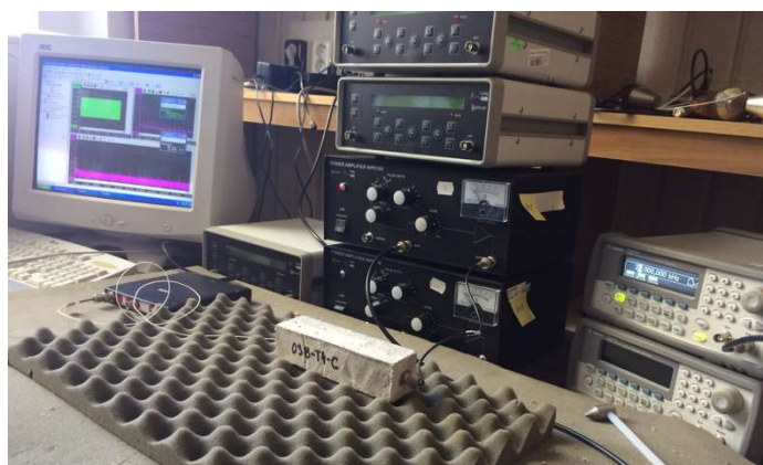
Obr. 53 Měřící aparatura metody nelineární ultrazvukové spektroskopie
