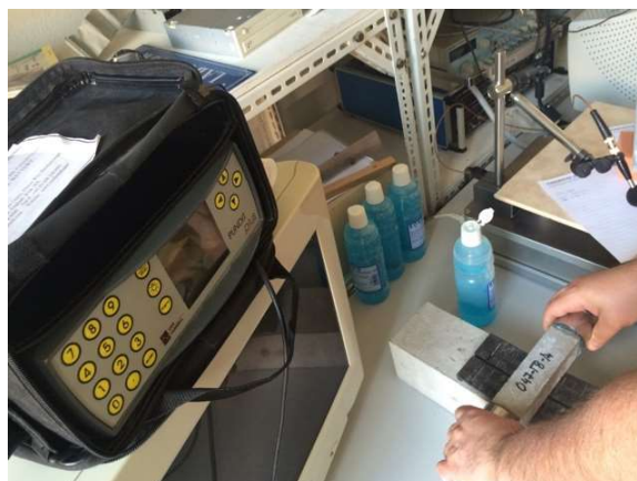
Obr. 41 Aparatura pro měření ultrazvukové impulzové metody
