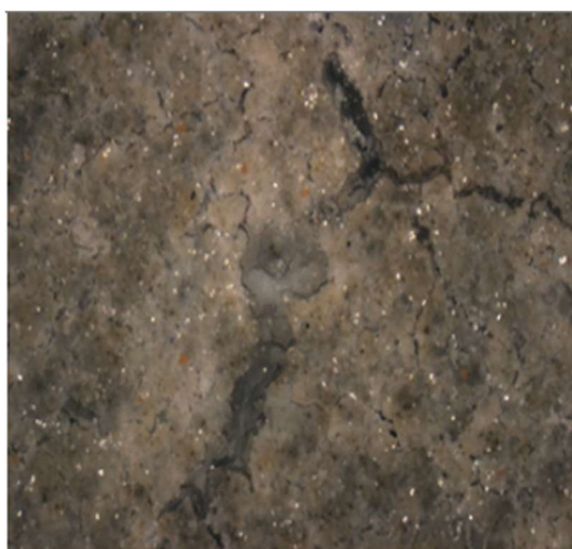
Obr. 50 Zobrazení struktury povrchu vzorku s teplotou výpalu 600 °C pomocí konfokálního mikroskopu
