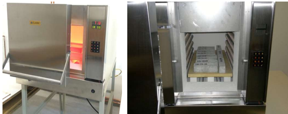
Obr. 29 Laboratorní pec se vzorky po tepelné degradaci
