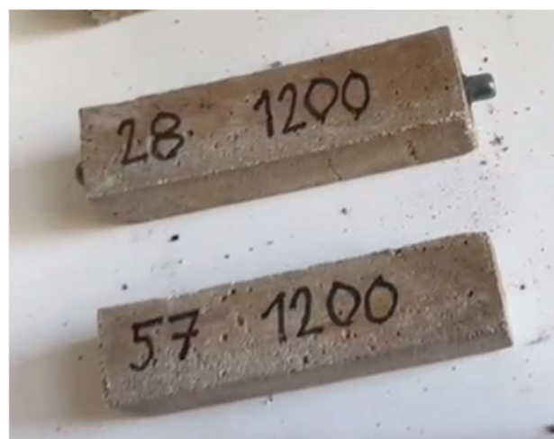
Obr. 67 Zkušební tělesa s výztuží i bez výztuže vypálené na teplotu 1200 °C
