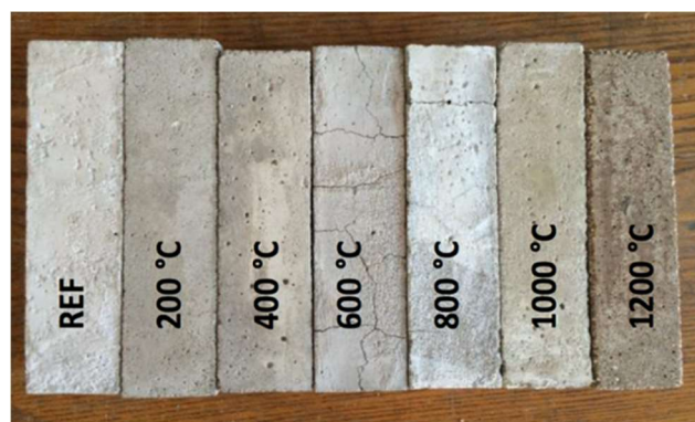
Obr. 30 Zkušební tělesa po tepelné degradaci
