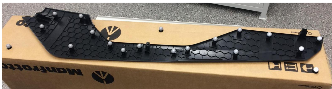
Obrázek 30: Výrobek měřený Vicon Motion Capture [vlastní]
