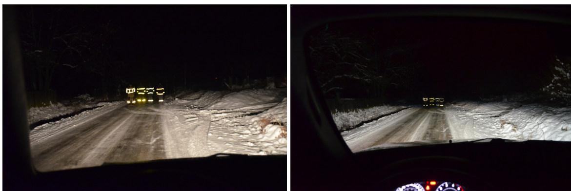
Obr. 38: Pozorování oděvů v nočních hodinách z přední strany (vlevo halogenové světlomety, vpravo xenonové světlomety) [vlastní]
