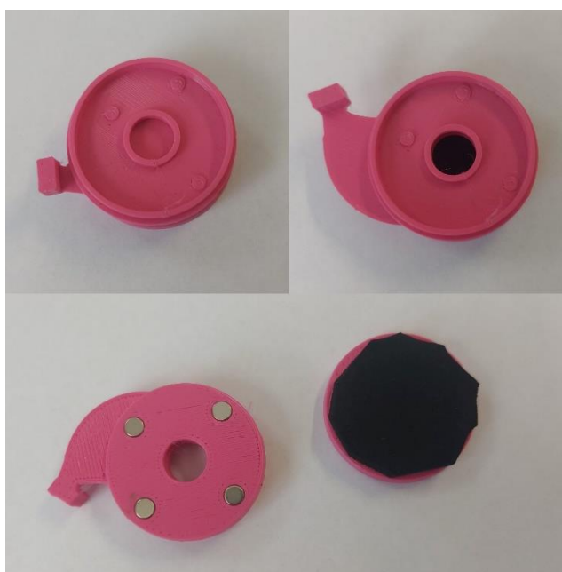
Obr. 13 Vytisknutá listová svorka. První fotografie vpravo – svorka se zatemněným otvorem pomocí plastové destičky. Fotografie vlevo – svorka s odtemněným otvorem s oddělanou plastovou destičkou. Fotografie dole – pohled na rozloženou svorku, která u sebe drží pomocí malých magnetů. Na spodní straně přidělaný kus molitanové hmoty sloužící jako tmavý podklad (Dobšíková, 2023).
