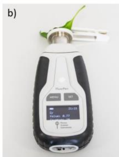
Obr.7 Ilustrační fotografie přístroje FluorPen FP 110 spolu s listovou svorkou (Manuál FluorPen 2021).
