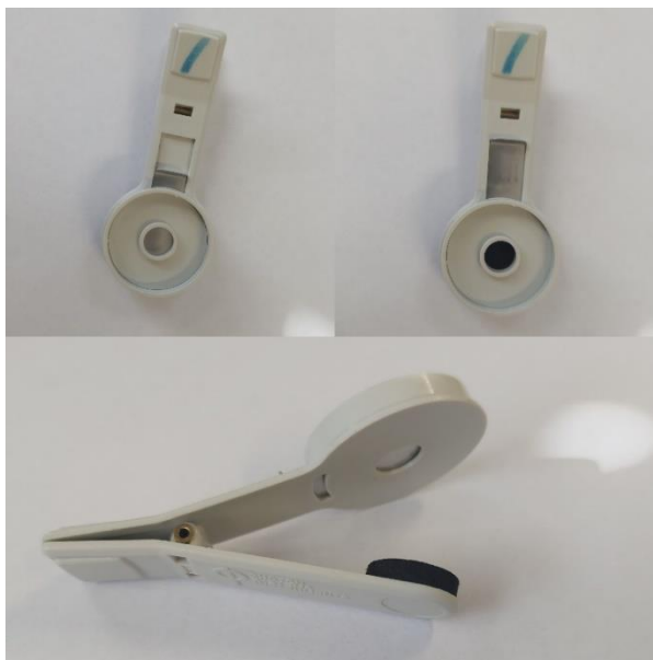
Obr. 12 Originální listová svorka. První fotografie vpravo – svorka se zatemněným otvorem pomocí kovové destičky. Fotografie vlevo – svorka s odtemněným otvorem s oddělanou kovovou destičkou. Fotografie dole – pohled na svorku z boku, klipový mechanismus včetně na spodní straně přidělaný kus molitanové hmoty sloužící jako tmavý podklad (Dobšíková, 2023).
