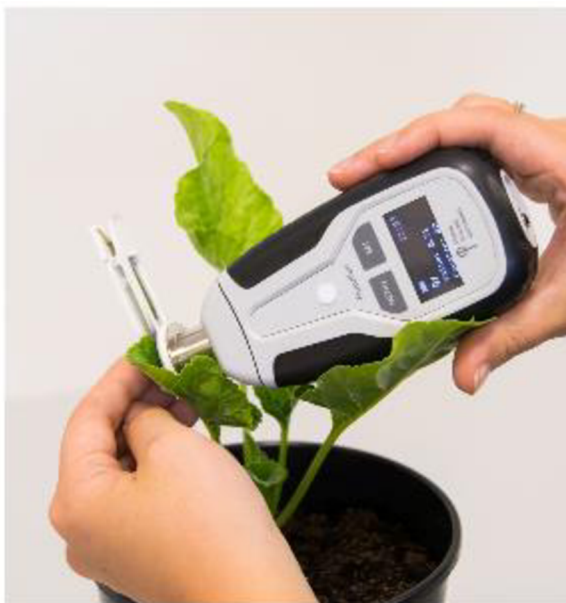
Obr. 8 Simulace měření, připevnění svorky na list a přiložení listové svorky na FluorPen FP 110 a samotné přikládání Fluorpeny FP 110 na svorku (Manuál FluorPen 2021).
