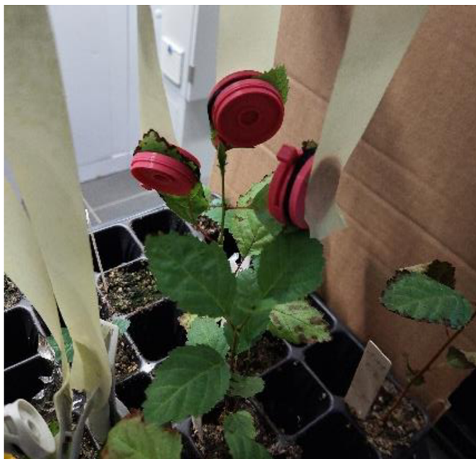
Obr. 11 Vytisknuté listové svorky na 3D tiskárně, připevněné lepicí páskou ke kartonové konstrukci. A následně byly umístěny v počtu 3 kusů na listy jedné z rostlin, v zatemňující fázi (Dobšíková, 2023).
