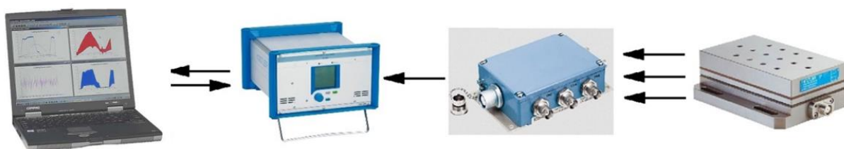
Obr. 3.3 schéma měření řezných sil. [26]
