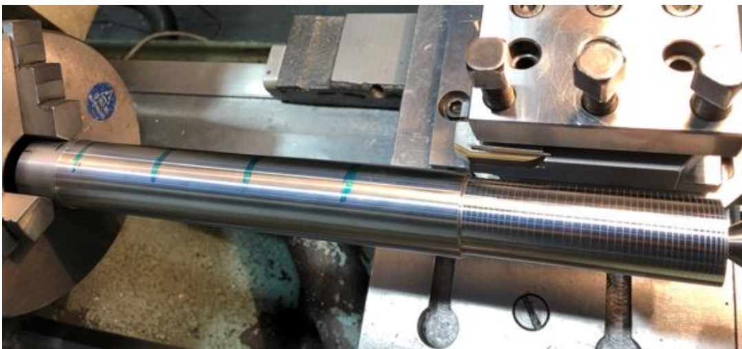
Obr. 3.9 Upnutí břitové destičky.
