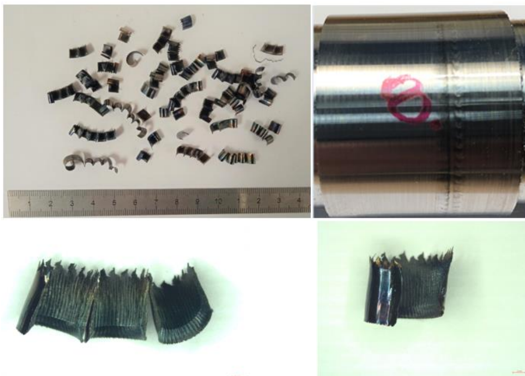
Obr. 3.31 Třísky a obrobený povrch, VBD 8.
