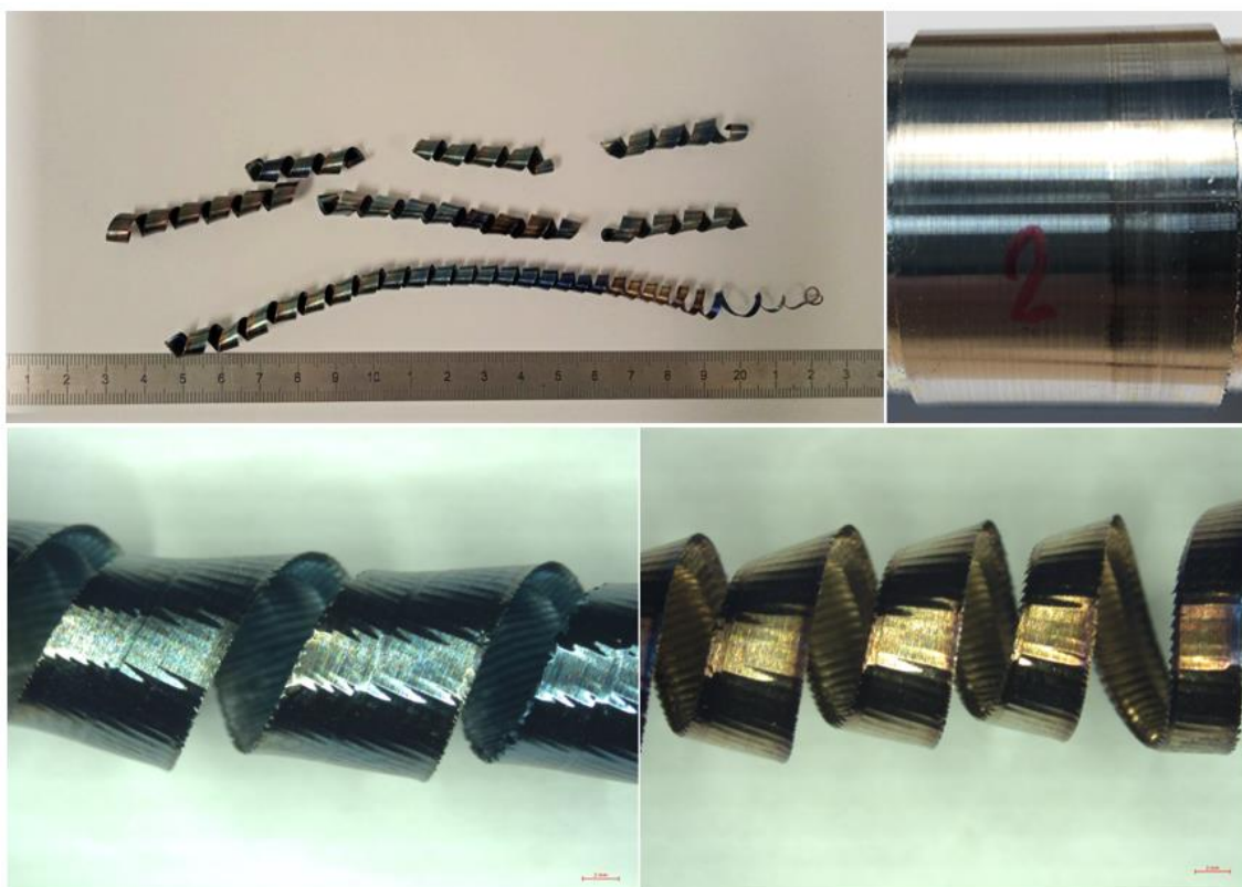
Obr. 3.25 Třísky a obroběný povrch, VBD 2.
