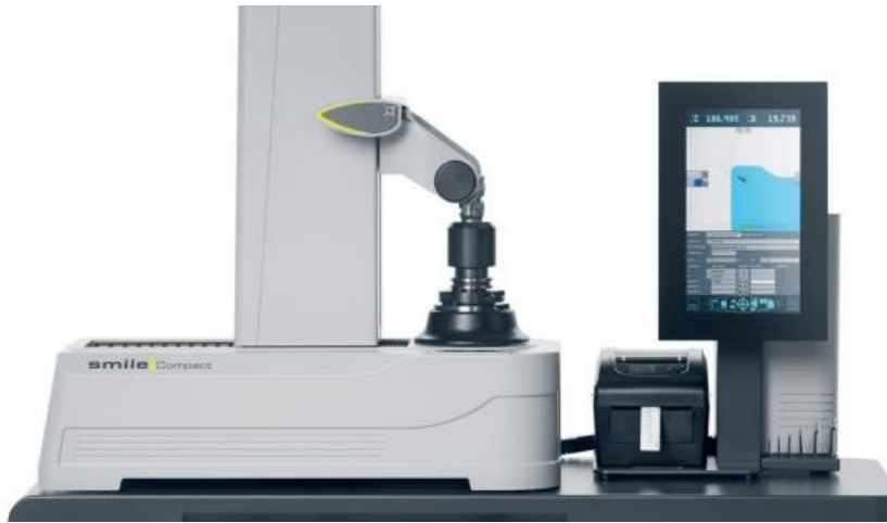
Obr. 4.7 Měření nástroje na ustavovacím zařízení [30].
