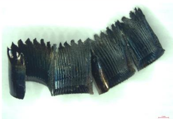
Obr. 3.30 Třísky a obrobený povrch, VBD 7.
