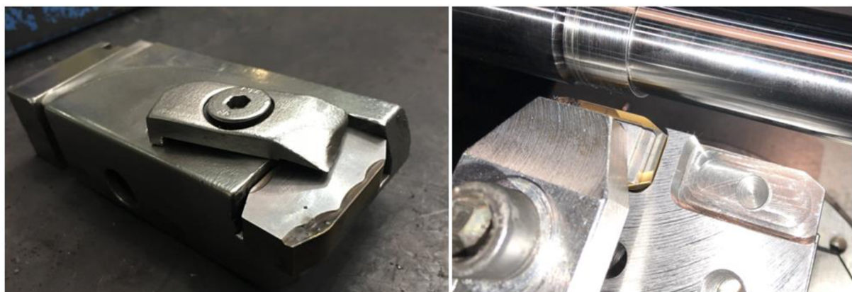
Obr. 3.7 Upnutí břitové destičky. Zleva: stávající stav upnutí destičky v provozu. Zprava: upnutí břitové destičky v držáku na VUT v Brně.
