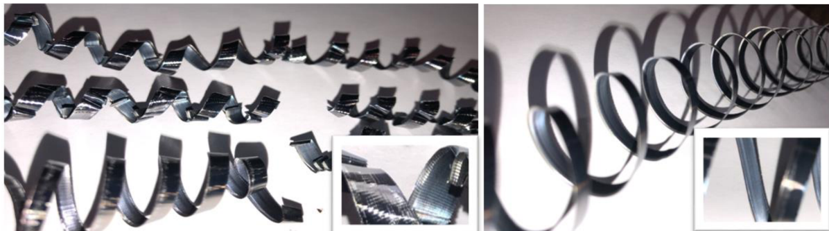
Obr. 3.14 Tříska, odcházející z řezu; a) VBD – A; b) VBD – B
