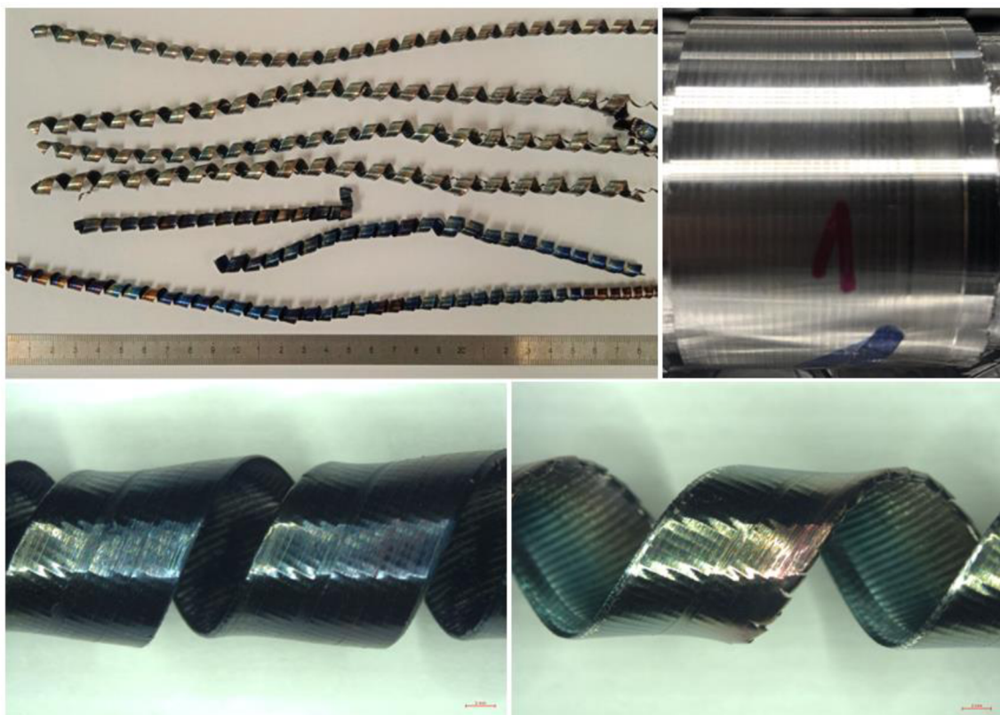
Obr. 3.24 Třísky a obroběný povrch, VBD 1.
