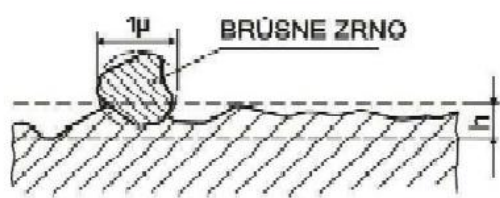
Obr. 15 princip broušení (Konečná, 2010)
