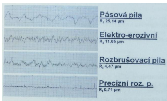
Obr. 12 drsnost povrchu po různém dělení (Michna a Kuśmierczak, 2012)
