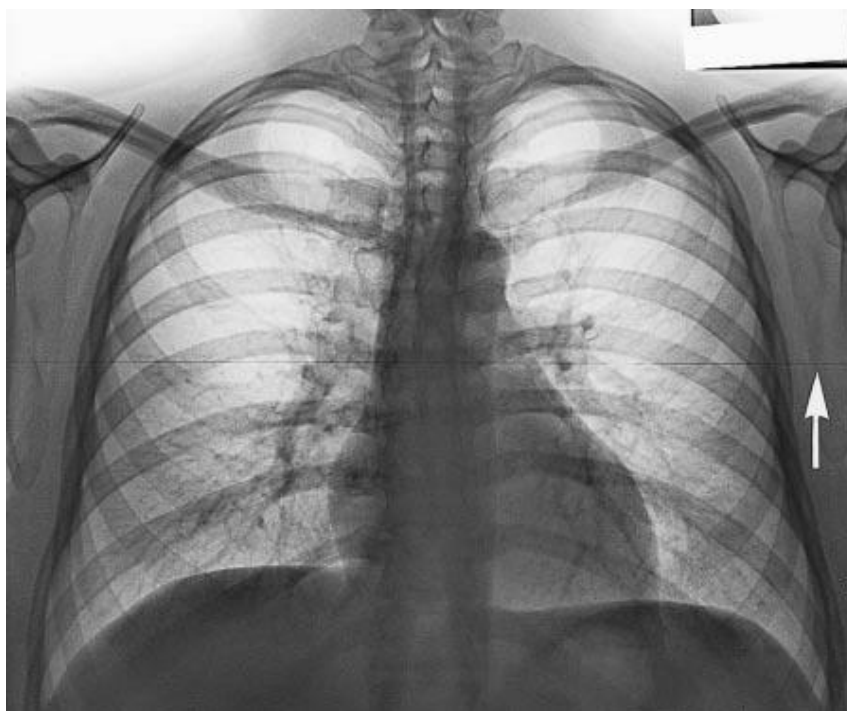
Obr. 7 [8] Linie způsobená závadou na optice čtečky /chyba čtečky/
