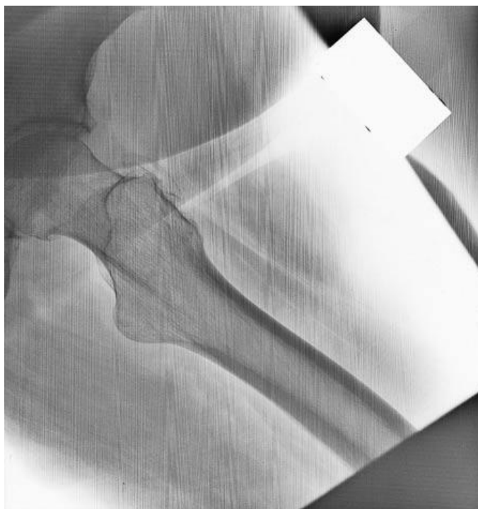
Obr. 6 [8] Vzorek čar na snímku způsobený vadnou elektronikou čtecího zařízení /chyba čtečky/
