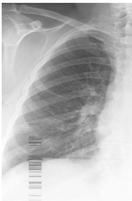
Obr. 11 [9] Chyba DR detektoru /chyba čtecího zařízení/
