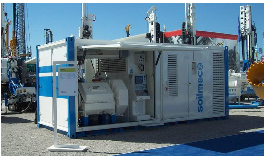
Obrázek 3-5: Čerpací a tlaková stanice tryskové injektáže [12]
