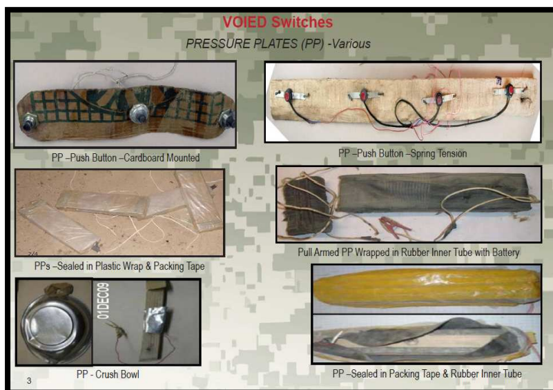
Obrázek 10: Příklady tlakových spínačů VOIED
