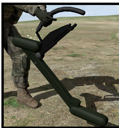
Obrázek 16: Detektor GOLDIE ke zjišťování povelových vodičů
