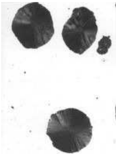
Obr.2 Struktura litiny s kuličkovým grafitem
