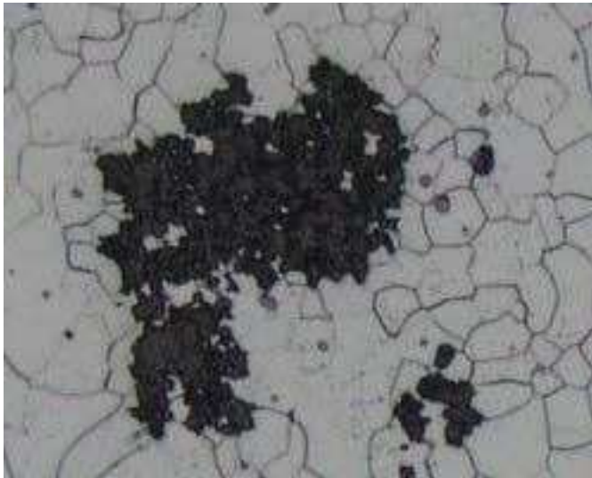
Obr.5 Struktura temperované litiny s černým lomem
