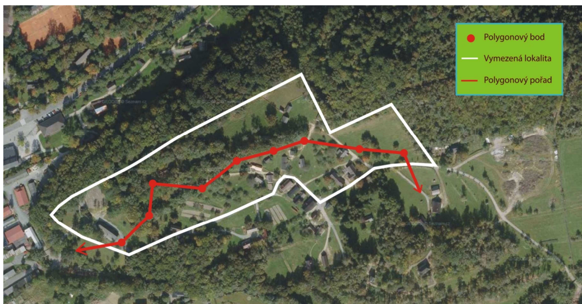
Obr. 5: Zhuštění bodového pole polygonovým pořadem
