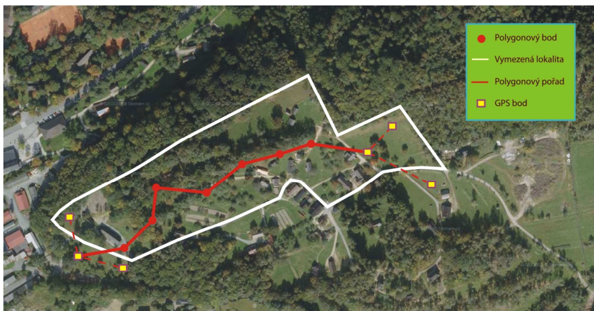
Obr. 6: Zhuštění bodového pole metodou GNSS
