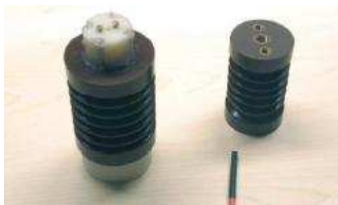
Obrázek 19 Bezindukční vysokonapětový dělič (vlevo) založený na sériovém vyráběném epoxidovém izolátoru (vpravo)
