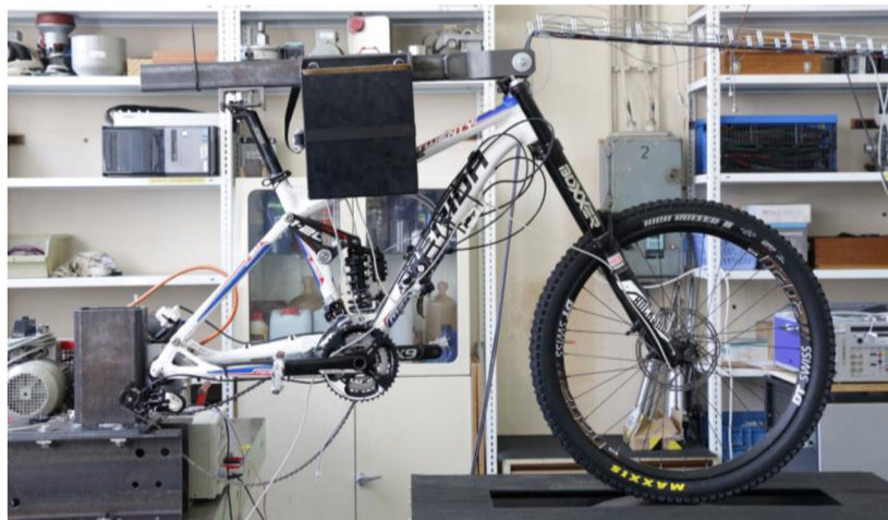
Obr. 6-28 Overenie funkčnosti stanici Dynotec.
