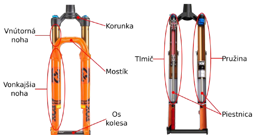
Obr. 2-3 Konštrukcia teleskopickkej vidlice [15].
