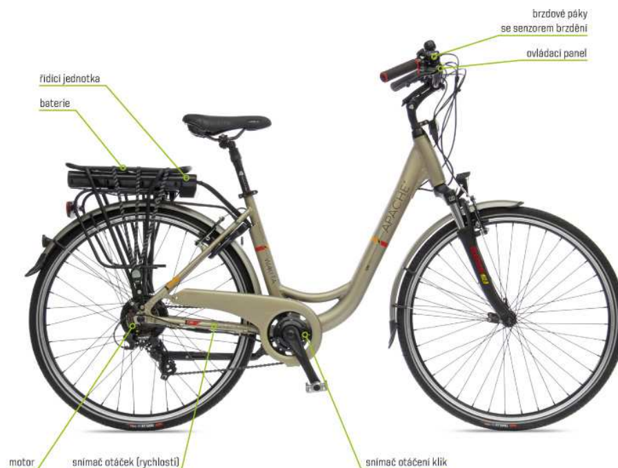
Obr. 9 Zobrazení umístění jednotlivých komponent na elektrokole [20]
