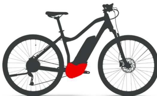
Obr. 7 Znárodnění umístění středového motoru [23]
