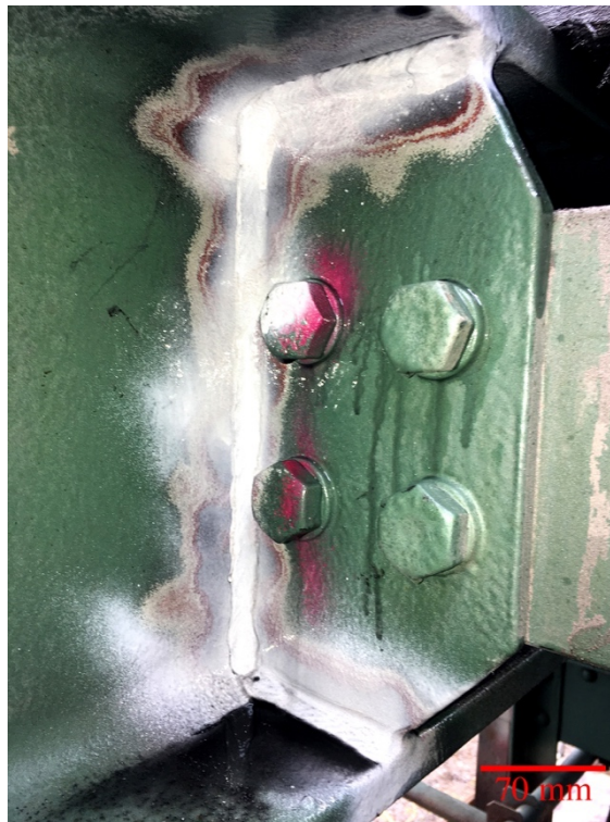
Obr. 3.9: Svar odzkoušený magnetickou práškovou metodou.
