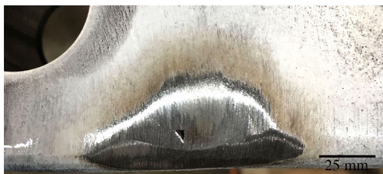
Obr. 2.5: Dutina ve svaru indikovaná magnetickou práškovou metodou.
