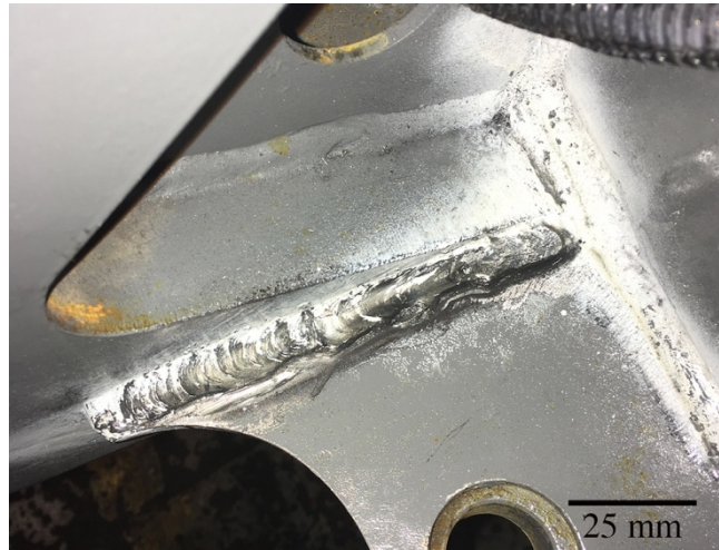
Obr. 3.1: Přímá vizuální kontrola svaru nosného dílu jeřábu po nehodě – dle VT je svar nepřijatelný.
