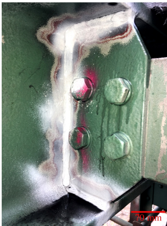
Obr. 3.9: Svar odzkoušený magnetickou práškovou metodou.
