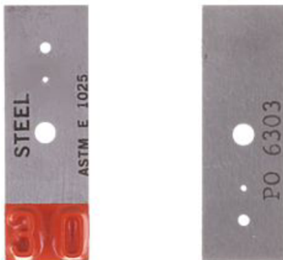
Obr. 3.28: Otvorová měrka dle normy ASTM [32].
