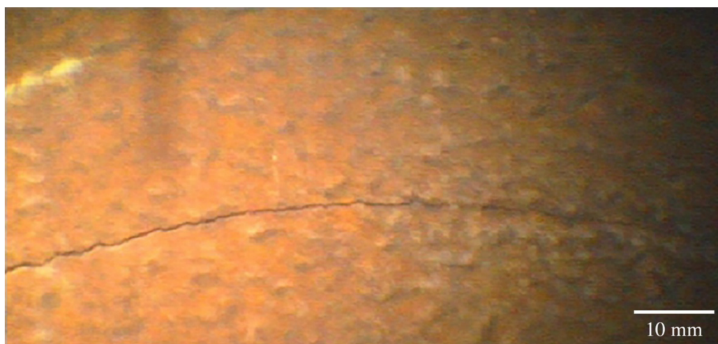
Obr. 3.2: Trhлина zjištěná pomocí videoskopu při nepřímé vizuální kontrole [7].
