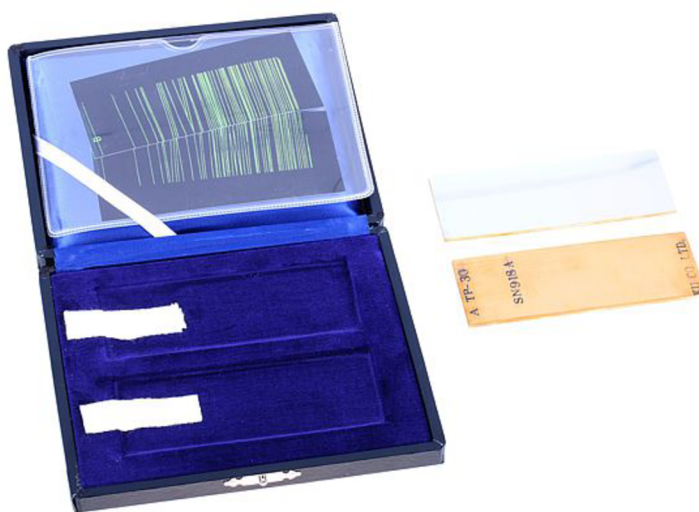
Obr. 3.8: Kontrolní měřka typu 1 pro kapilární zkoušku [15].
