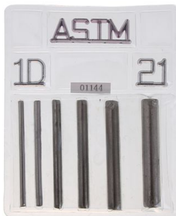
Obr. 3.29: Drátková měrka dle normy ASTM [33].
