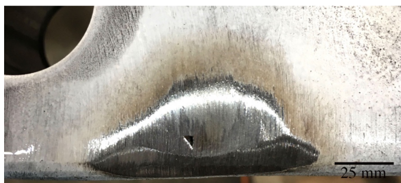
Obr. 2.5: Dutina ve svaru indikovaná magnetickou práškovou metodou.
