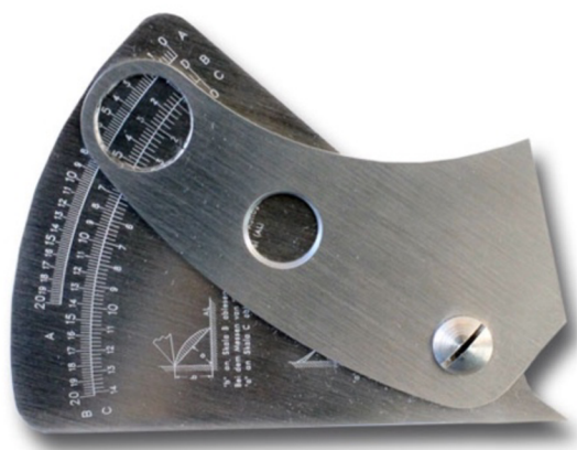
Obr. 3.3: Měrka pro měření koutových svarů [9].
