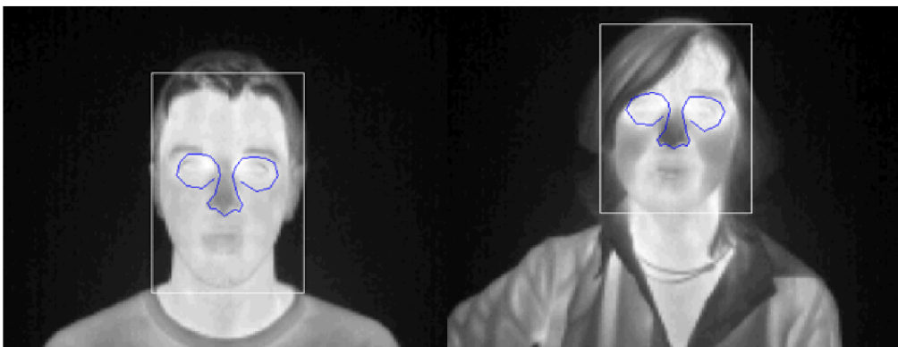
Obr. 4.10: Ukázka detekovaných částí obličeje technikou AAM.
