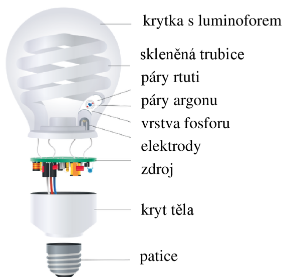
Obr. 2-14 Schéma zářivky, upraveno podle [30]
