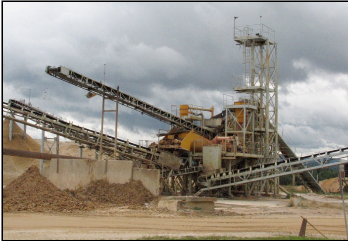
Obrázek 3: Třídící linka užívaná při těžbě mokrým způsobem, Dřenice u Chebu
