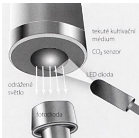
Obrázek 3: Princip kolorimetrické detekce změny pH způsobené produkcí CO 2 množícími se bakteriemi v hemokultuře (upraveno podle Čermák et al., 2008).
