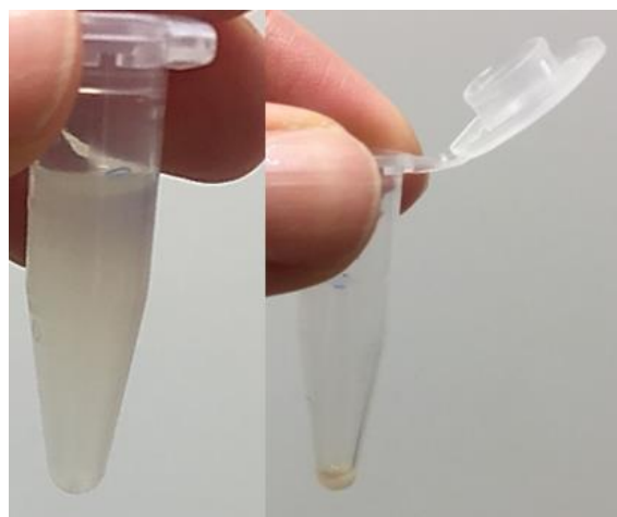
Obrázek 6: Mikrozkumavka 1,5 ml – v levé části je zkumavka s rozmíchanou peletou ve směsi s 300 µl H 2 O a 900 µl 96% ethanolu před centrifugací. V pravé části je zkumavka po centrifugaci, supernatant byl odstraněn, v dolní části zkumavky viditelná peleta.
