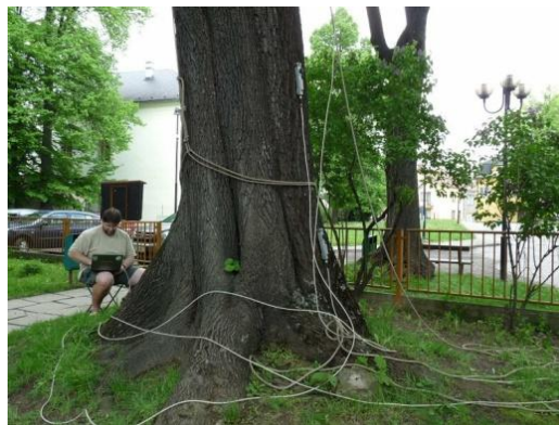
Obrázek 49: Provádění tahové zkoušky, zdroj: SAFE TREES, s.r.o.
