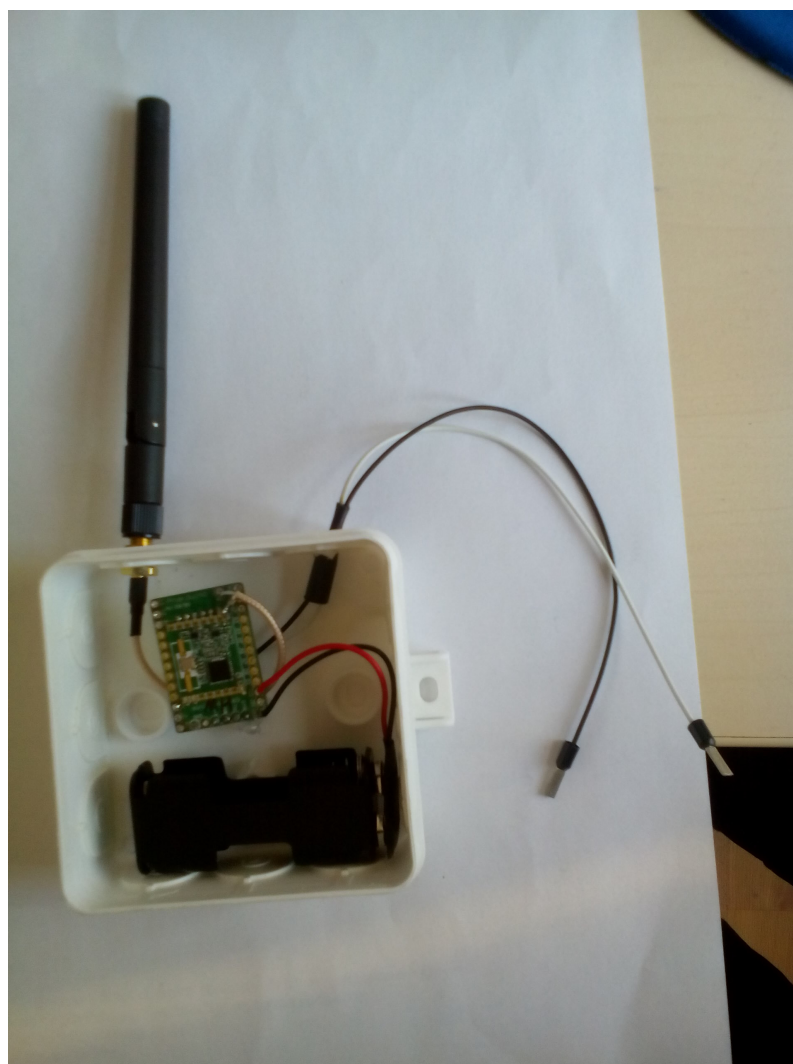
Obrázek C.2: Vysílací modul Arduino ve speciálním plastovém boxu
