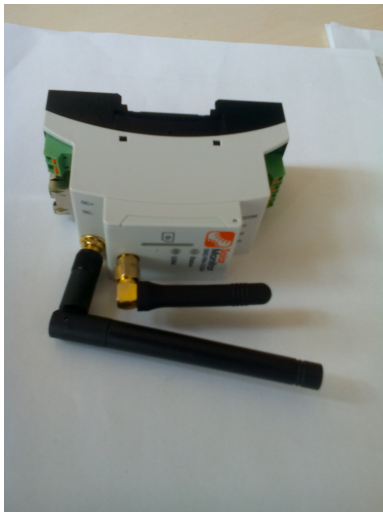
Obrázek C.1: Přijímací modul Arduino umístěný v modulu SM2-RM-GSM
