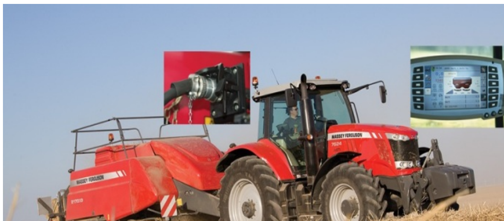
Obrázok č. 22 – Zapojenie ISO-Bus systému na stroji
