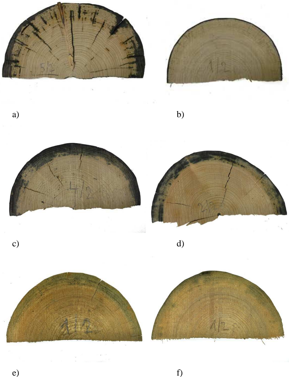
Obr. 10 Zkušební vzorky po impregnaci při různých vlhkostech: a) w = 0 \% , b) w = 10 \% , c) w = \text{MH} , d) w = 40 \% , e) w = 60 \% , f) w = 80 \% a více
