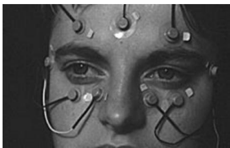
Obr. 12: Ukázka EOG měření (zdroj: Duchowski, 2007).
