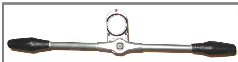
Obr. 7 Momentový klíč s dvouramenným vratidlem a číselníkovým ukazatelem [11]
