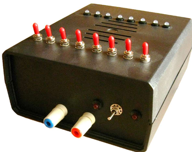
Obr. 20. Ovládací panel ventilů
