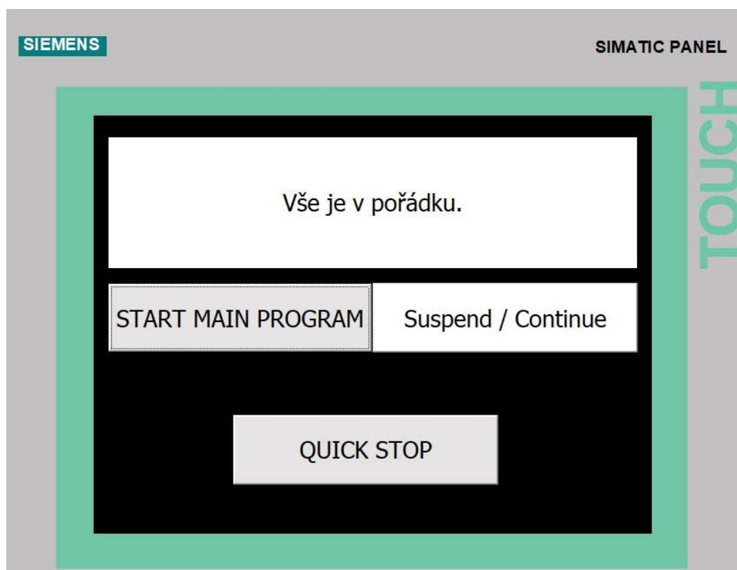
Obrázek 5.3: Vytvořený panel v programu WinCC
