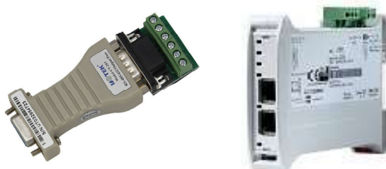
Obrázek 4.3: Redukce pro propojení PLC s LI100. Redukce z RS232 na RS485 vlevo [19] a redukce na PROFIBUS [18] vpravo.
