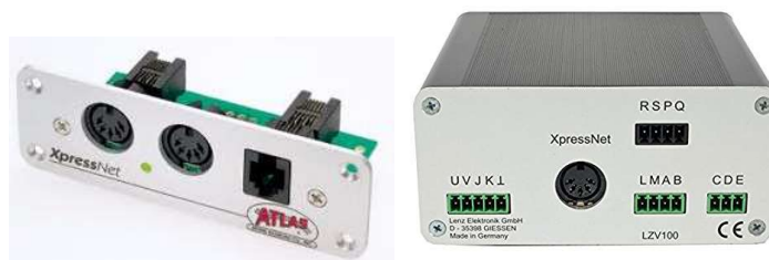
Obrázek 2.12: Možnosti připojení ovladače do sítě XPressNet
