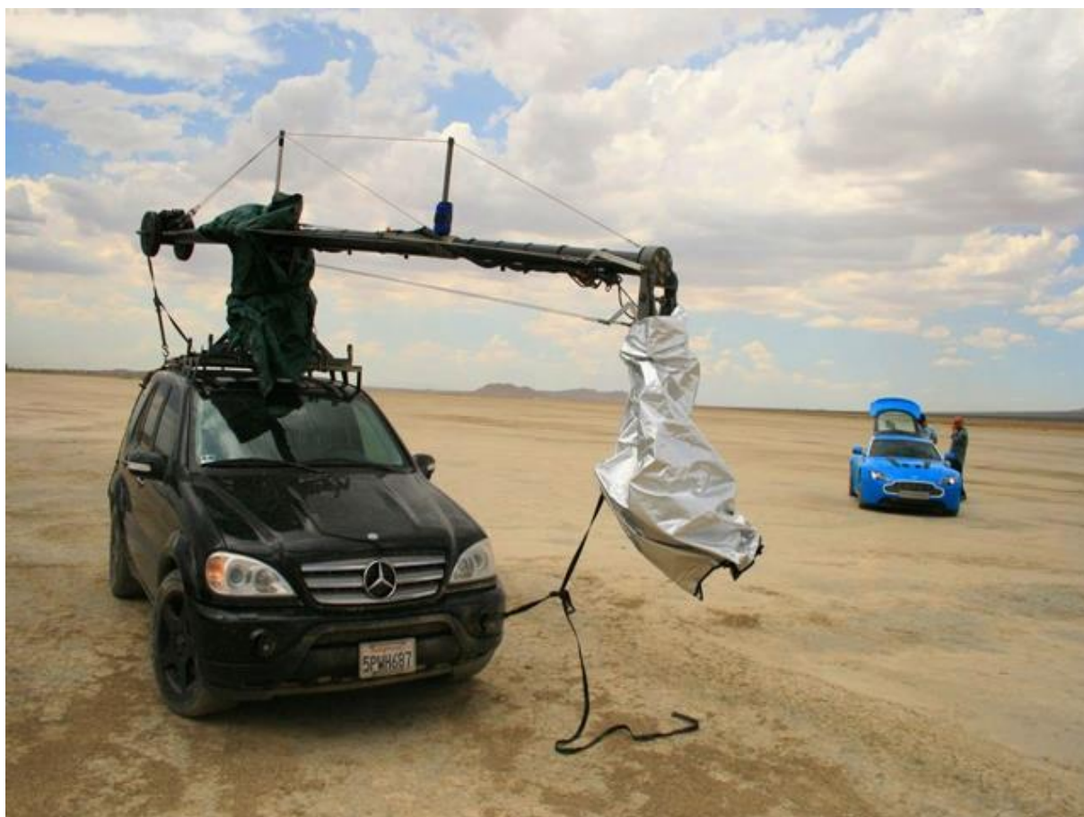
Obrázek 1 Použití kamerového jeřábu na doprovodném vozidle
