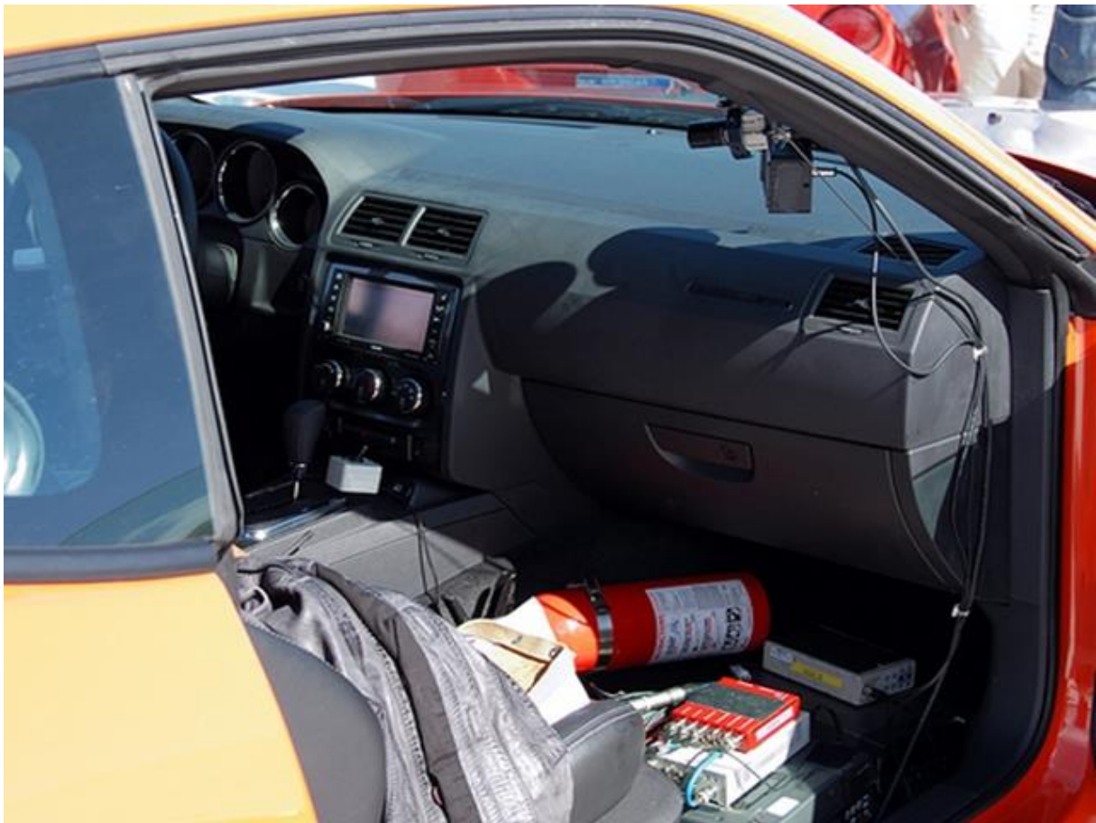
Obrázek 2 Použití onboard kamery namířené na řidiče v pravém horním rohu interiéru vozidla
