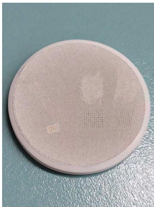
Obr. 5.15: Fotografia vzorky cementovej pasty T04, viditeľná spolu s krátermi po meraniach.
