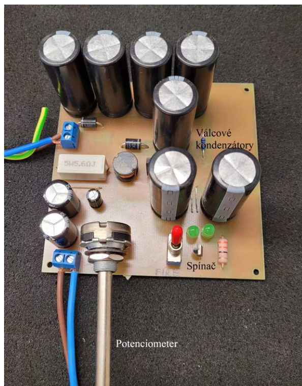
Obr. 5.1: Fotografia iskrového generátora navrhnutého a vyrobeného Ing. Martinom Žilkom. Pozostáva zo siedmych valcových kondenzátorov, spínača, usmerňovacej diódy, odporu a potenciometeru.
