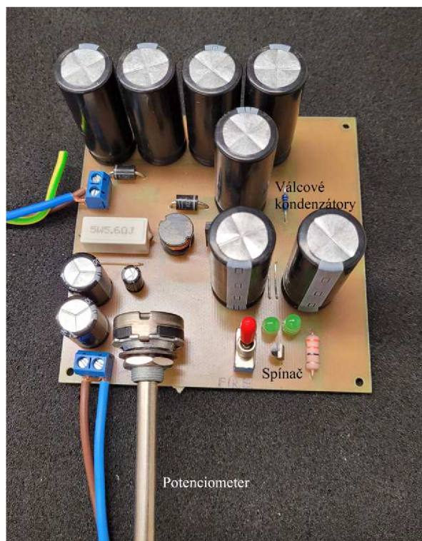
Obr. 5.1: Fotografia iskrového generátora navrhnutého a vyrobeného Ing. Martinom Žilkom. Pozostáva zo siedmych válcových kondenzátorov, spínača, usmerňovacej diódy, odporu a potenciometeru.
