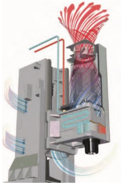
Obr. 31 Chlazení vřeteníku u vertikálních obráběcích center firmy HASS [15]
