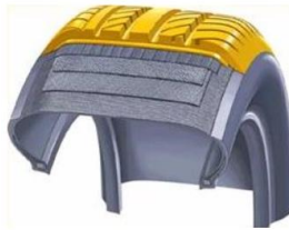
Obr. 3 Umístění části běhounu na plášti, na obrázku vyznačeno žlutě. [4]
