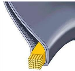
Obr. 9 Detail patního lana (žlutě). [4]
