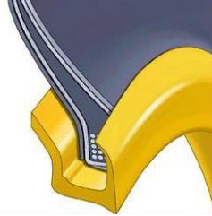
Obr. 8 Detail usazení patního lana s přehnutými konci kostry (apex) do patky (žlutě). [4]
