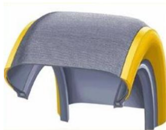
Obr. 5 Umístění bočnic na plášti, na obrázku vyznačeno žlutě. [4]
