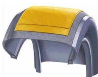
Obr. 6 Umístění nárazníku na plášti, na obrázku vyznačeno žlutě. [4]
