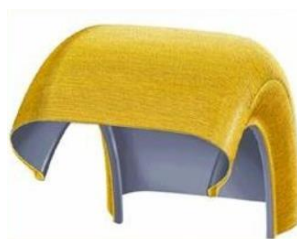
Obr. 2 Kordová vrstva pláště, na obrázku vyznačeno žlutě. [4]
