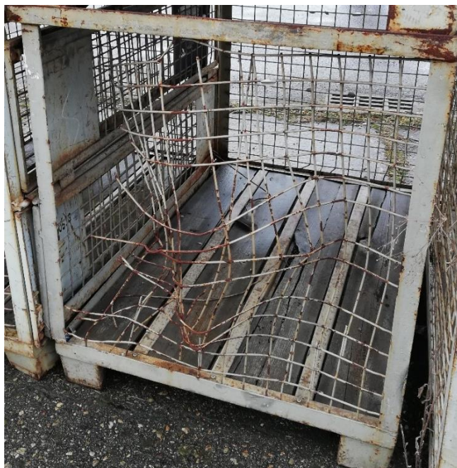
Obr. 19: Poškozený gitterbox (Zdroj: Vlastní zpracování)
