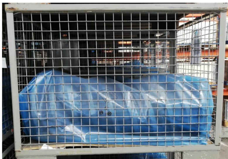
Obr. 15: Gitterbox s výrobkem v antikorozi pytle (Zdroj: Vlastní zpracování)
