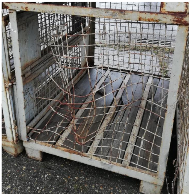
Obr. 19: Poškozený gitterbox (Zdroj: Vlastní zpracování)
