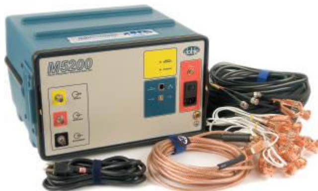
Obr. 6.4: Fotografie měřicího přístroje SFRA Doble M5200 [7]
