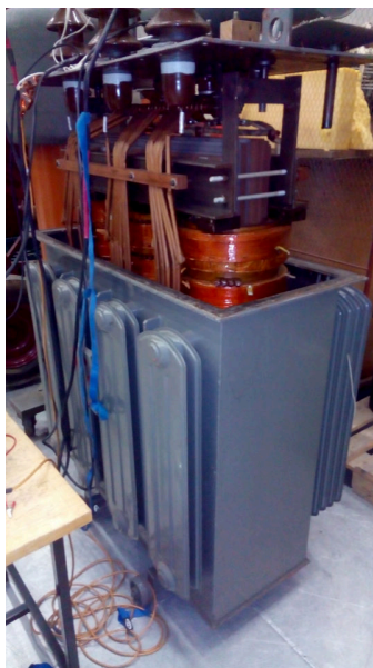
Obr. 6.2: Fotografie měřeného transformátoru
