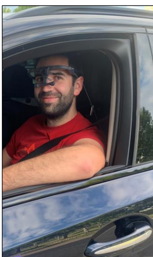
Obr. 15: Proband se zařízením Eyetracker Dikablis Glasses [39]
