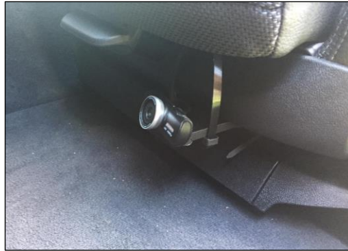
Obr. 18: Ukázka umístění kamery pod sedadlem řidiče [39]
