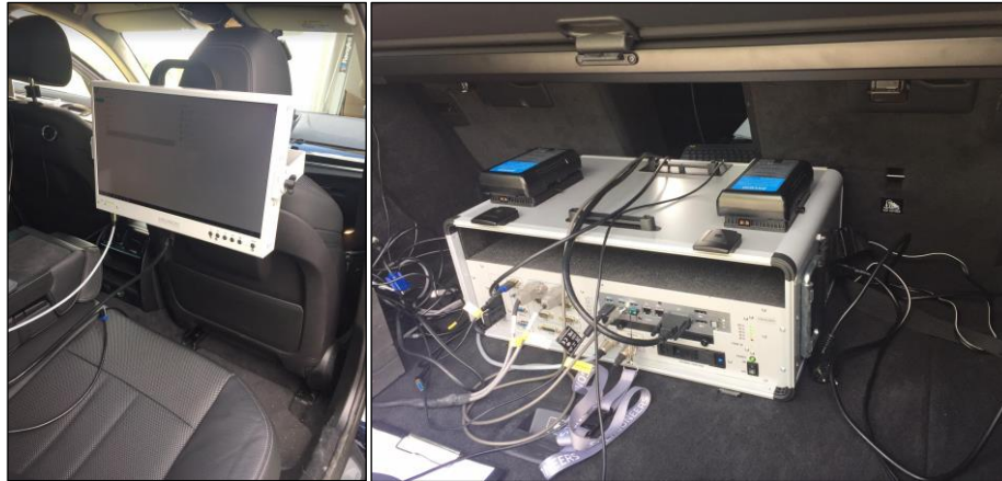
Obr. 16: Zařízení VTK s kontrolním displejem [39]
