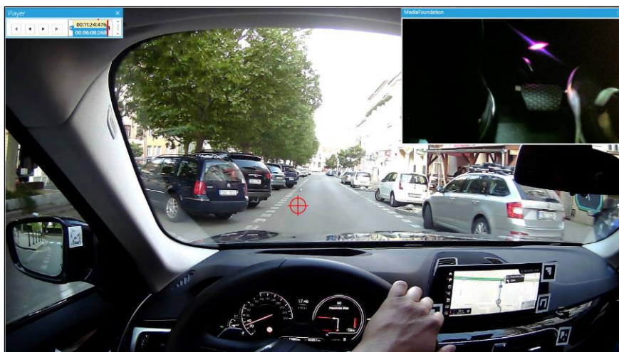
Obr. 24: Počátek uvolnění akceleračního ho pedálu, konec psychické reakce, počátek doby přemístění [39]
