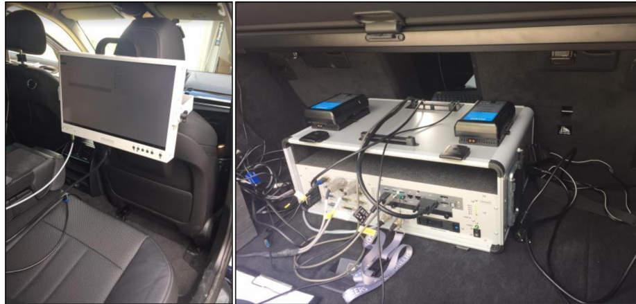
Obr. 16: Zařízení VTK s kontrolním displejem [39]
