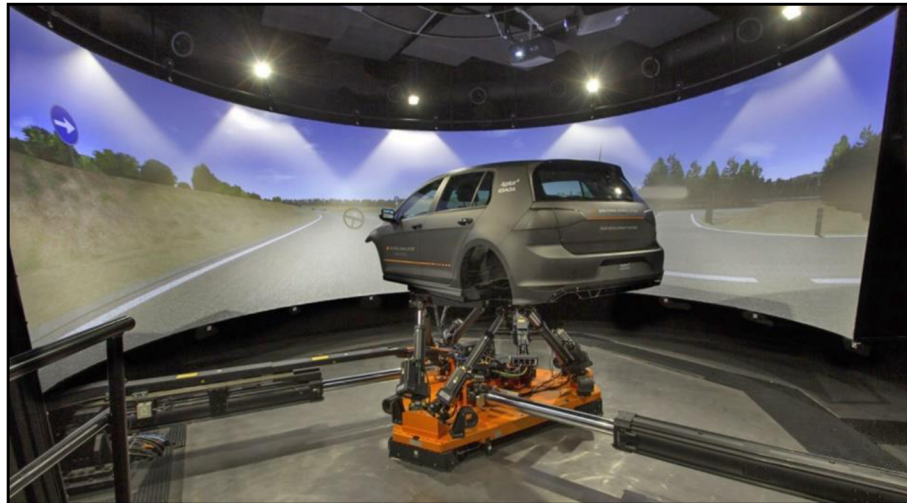
Obr. 10: Víceúčelový jízdní simulátor společnosti Goodyear [42]
