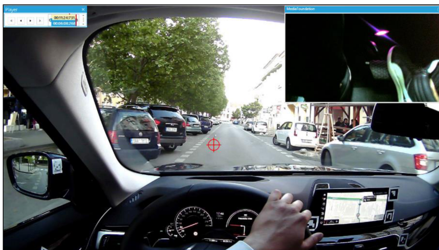
Obr. 25: Přemístění nohy řidiče na brzdový pedál, konec doby přemístění a celkové doby reakce brzděním [39]
