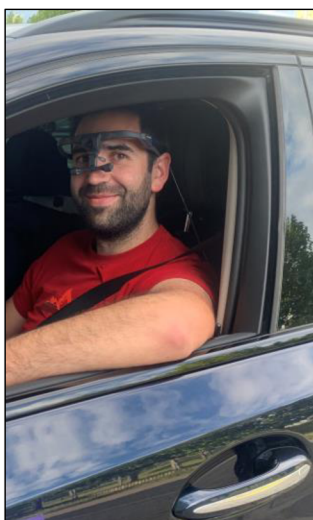
Obr. 15: Proband se zařízením Eyetracker Dikablis Glasses [39]
