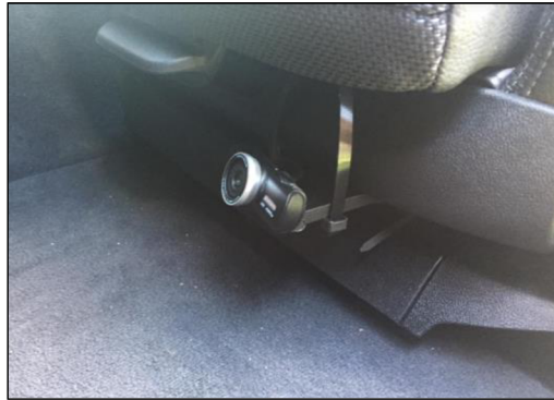
Obr. 18: Ukázka umístění kamery pod sedadlem řidiče [39]
