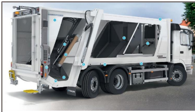
Obrázek 3-8 Svozové vozidlo s lineárním a otevřeným vyklápěčem
