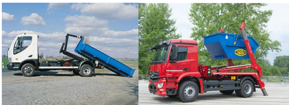
Obrázek 3-6 Jednoramenný hákový a dvojrámenný způsob nakládání kontejneru
