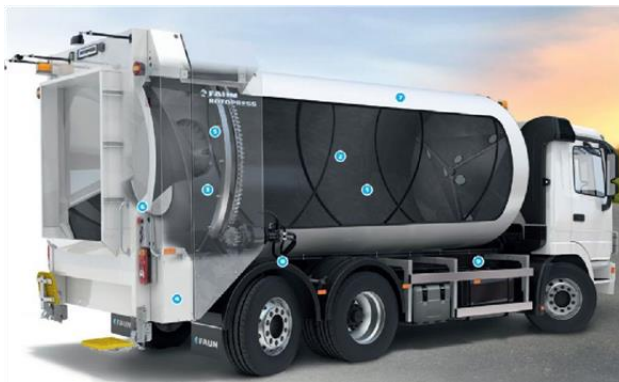
Obrázek 3-7 Svozové vozidlo s rotačním stlačováním a otevřeným vyklápěčem
