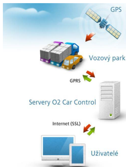
Obrázek 3-11 Přenos polohy vozu pomocí lokační služby GPS
