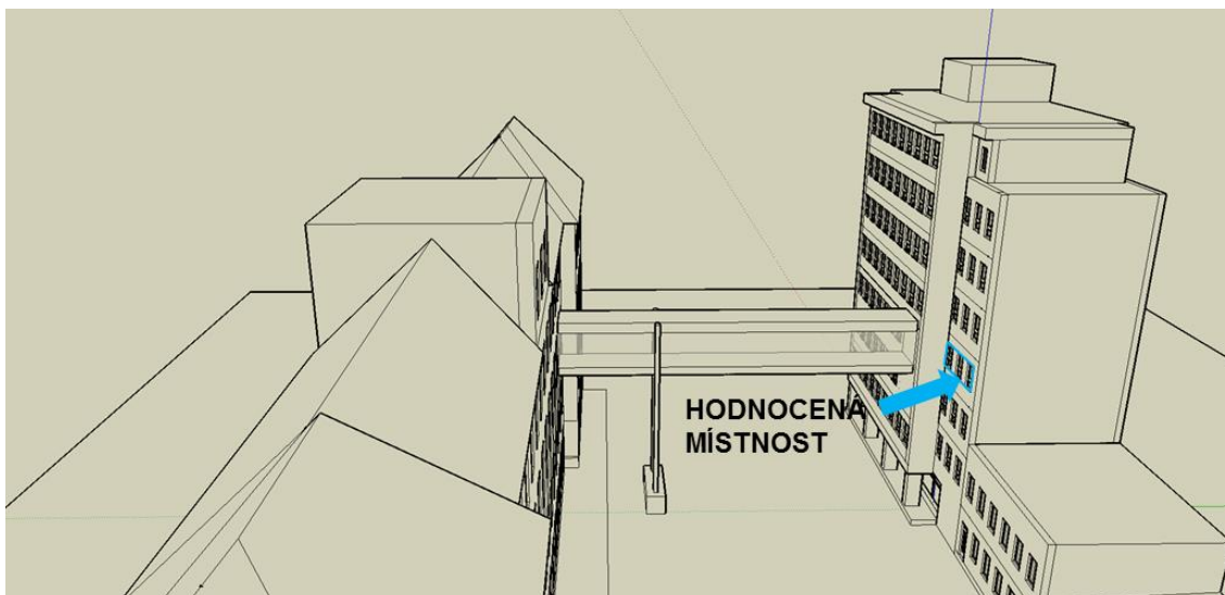
Obr. 5.5.17 Model pro světelné simulace v programu Daysim – měření in-situ v Brně (autor)
