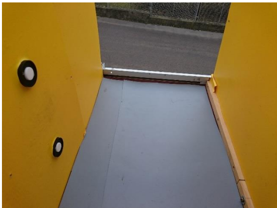
Vertikální překážka ve vzdálenosti 35 cm – měření vertikálních osvětleností
