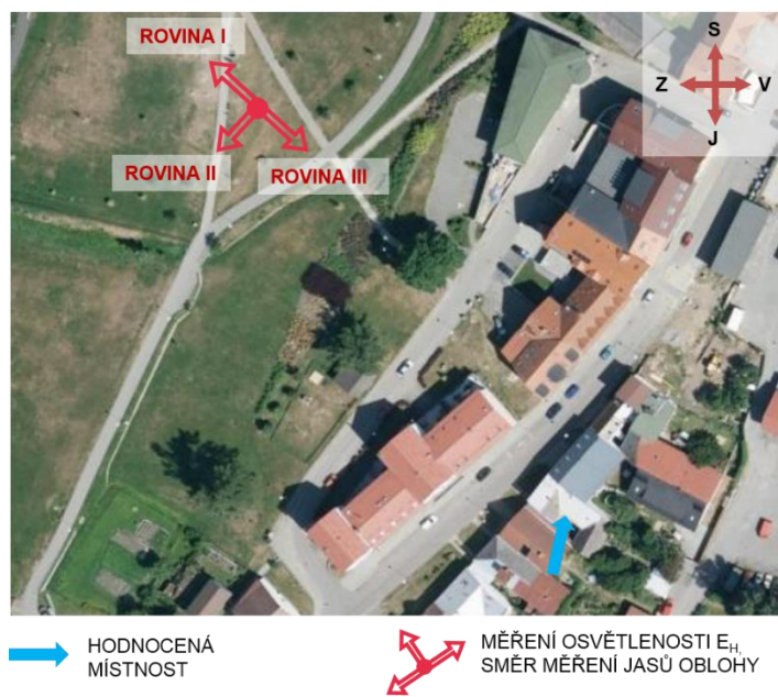
Obr. 5.5.6: Vyznačení umístění hodnocené místnosti a místa měření venkovních denních osvětleností E_H a jasů oblohy při měření in-situ ve Žďáru nad Sázavou (autor s využitím [135])
