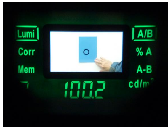
Obr. 5.5.1: Měření in-situ pro stanovení činitele odrazu světla venkovní stěny pomocí měření jasů etalonu jasoměrem Gossen Mavo-Spot 2 ve Žďáru nad Sázavou, vlevo fotografie jasoměru a etalonu, vpravo pohled do okuláru jasoměru Gossen Mavo-Spot 2 se zobrazením změřené hodnoty jasů na povrchu etalonu (autor)
