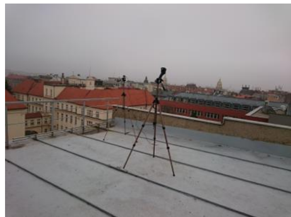
Obr. 5.5.16: Rozmístění jedné řady luxmetrů v měřené místnosti v Brně (vlevo); umístění jasoměru a luxmetru na venkovní horizontální rovině (vpravo) (autor)
