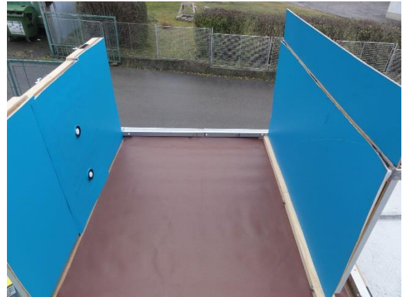
Vertikální překážka výšky 50 cm ve vzdálenosti 60 cm – měření vertikálních osvětleností
