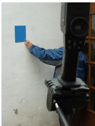
Obr. 5.5.1: Měření in-situ pro stanovení činitele odrazu světla venkovní stěny pomocí měření jasů etalonu jasoměrem Gossen Mavo-Spot 2 ve Žďáru nad Sázavou, vlevo fotografie jasoměru a etalonu, vpravo pohled do okuláru jasoměru Gossen Mavo-Spot 2 se zobrazením změřené hodnoty jasů na povrchu etalonu (autor)
