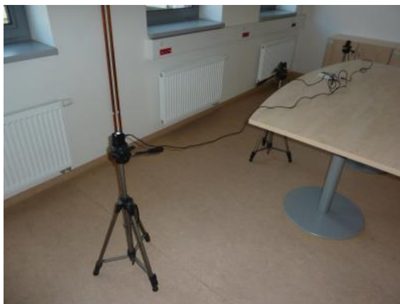
Obr. 5.5.16: Rozmístění jedné řady luxmetrů v měřené místnosti v Brně (vlevo); umístění jasoměru a luxmetru na venkovní horizontální rovině (vpravo) (autor)
