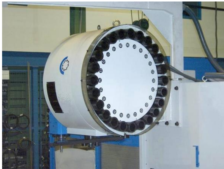
Obr. 36 Bubnový zásobník nástrojů ATC 2450. [27].
