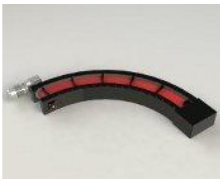
Obr. 27 Kruhový dopravník třísek od firmy ASTOS [17].
