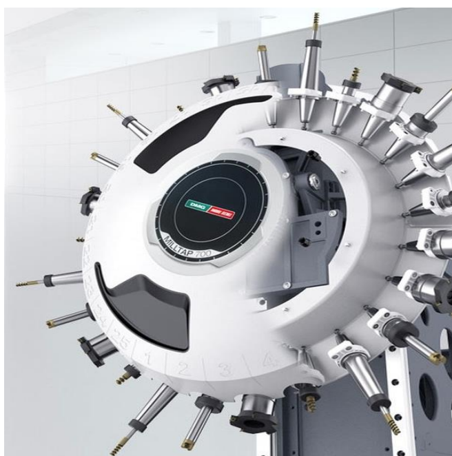
Obr. 35 Revolverový zásobník obráběcích center Mori Seiki. [27].
