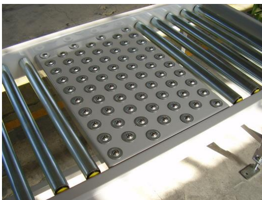
Obr. 15 Kuličkový stůl válečkové trati LOGSYS [10].
