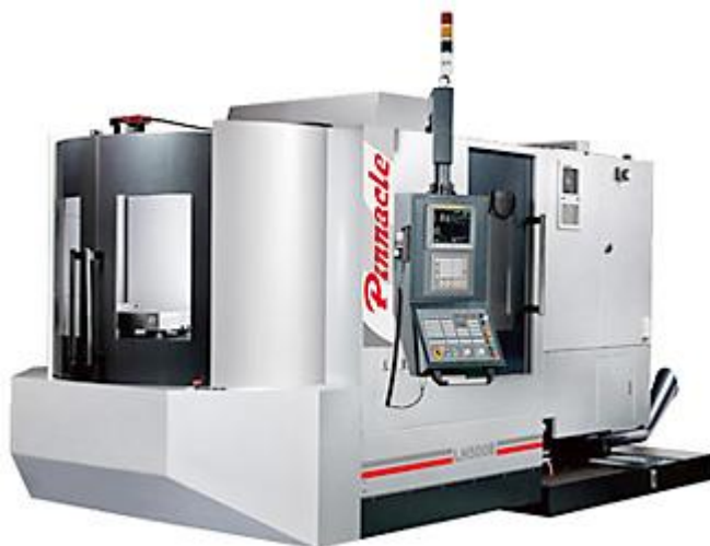
Obr. 31 Horizontální obráběcí centrum Pinnacle LH500. [24].
