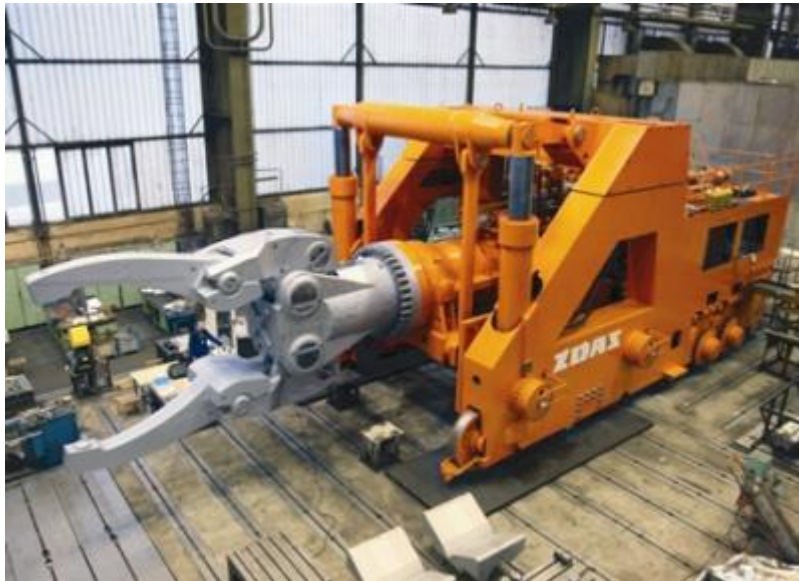
Obr. 11 Kovací manipulátor QKK 100° [6].
