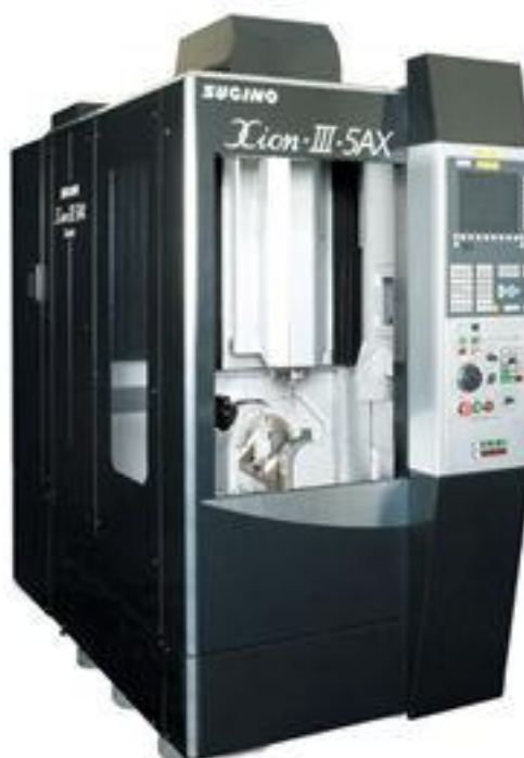
Obr. 39 Ultrapřesné OC schopné mikroobrábění Sugino Xion-III-5AX [31].
