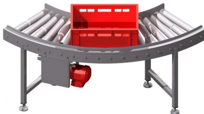
Obr. 18 Zatáčka válečkové trati, řešená válečky ve dvou řadách STRAND [9].
