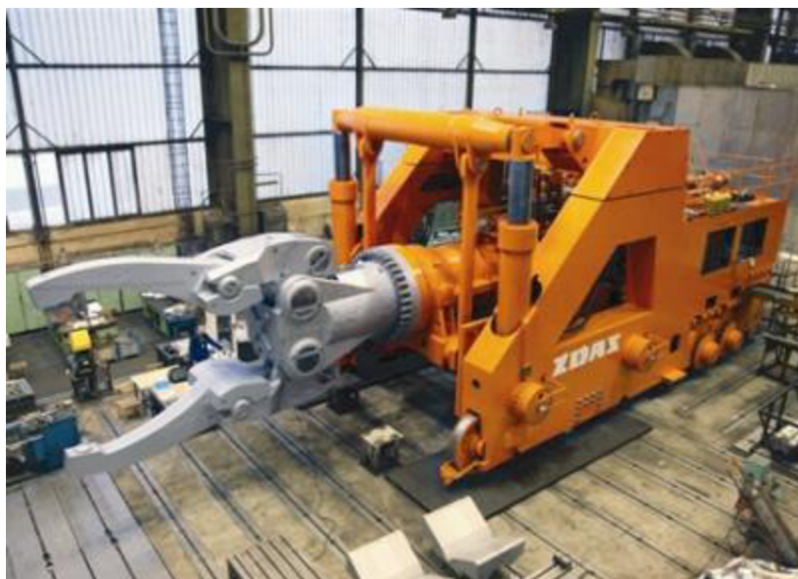
Obr. 11 Kovací manipulátor QKK 100° [6].
