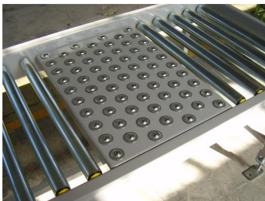
Obr. 15 Kuličkový stůl válečkové trati LOGSYS [10].
