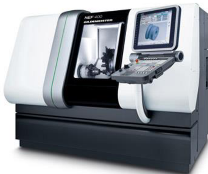
Obr. 41 Univerzální obráběcí centrum DMG MORI NEF 400 [33].
