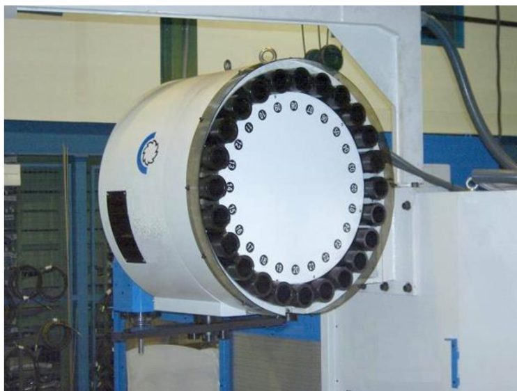
Obr. 36 Bubnový zásobník nástrojů ATC 2450. [27].
