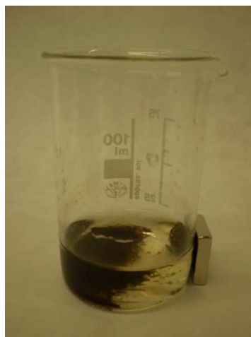
Obr. 18.: Demonstrace magnetických vlastností magnetitu v roztoku.
