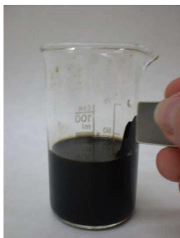
Obr. 13.: Pohyb koloidních částic magnetitu za magnetem.
