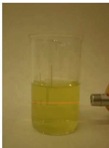
Obr. 25.: Demonstrace Tyndallova jevu v disperzi s nanočásticemi \text{Cu}_2\text{O} .
