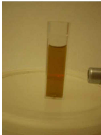
Obr. 27.: Demonstrace Tyndallova jevu v disperzi s nanočásticemi \text{Cu}_2\text{O} .
