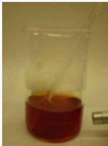
Obr. 6.: Demonstrace Tyndallova jevu v koloidní disperzi goethitu.
