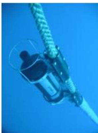
Obr. 1.6: Akustický srážkoměr pro měření srážek na moři (převzato z [12])
