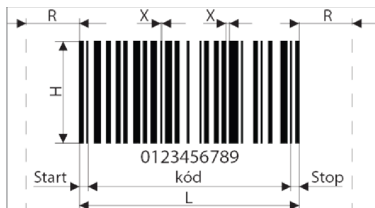
Obrázek 1: Čárový kód s vyznačenými parametry- převzato z [11]
